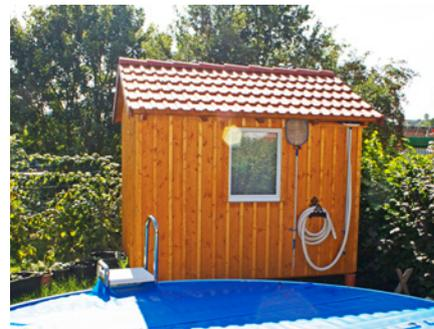
Die Holzkonstruktion besteht aus gehobelten Kanthölzern (12/12, 8/8, 8/12, 6/12) einschließlich Holzbau-Spax.
